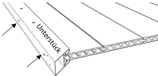
Das Unterstück des Rahmens verfügt über zusätzliche Drainagelöcher. Die Bretter unbedingt mit der Nut nach unten zeigend einsetzen.
