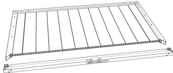
Verschrauben Sie die Rahmenecken mit den vormontierten Kunststoffwinkeln.
