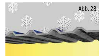
Mit Vlies: Kondenswasser wird aufgenommen und trocknet ab.
