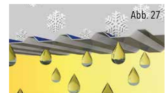
Ohne Vlies: Kondenswasser tropft ab.
