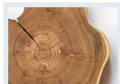
Abb. 1: Detailaufnahme, unbehandelte Holzoberfläche der Robinie vor der Bewitterung (Kern- und Splintholz).
