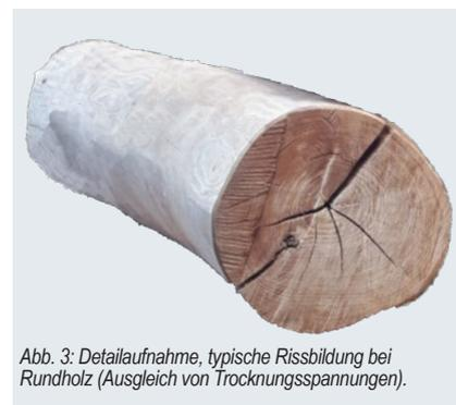
Abb. 3: Detailaufnahme, typische Rissbildung bei Rundholz (Ausgleich von Trocknungsspannungen).
