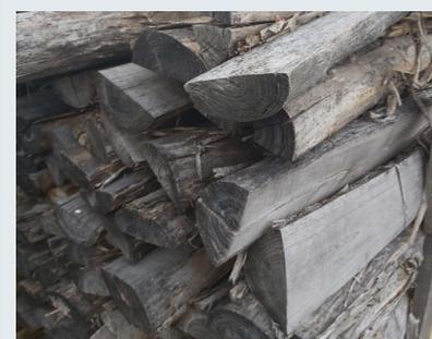
Abb. 2: Detailaufnahme, unbehandelte Holzoberfläche der Robinie nach ca. 2-3 Jahren Bewitterung (Kernholz). Eine silber-graue Patina beginnt sich zu bilden.
